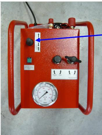
Actionner la **manette de commande (C)** vers « Close » → ←. La maintenir en position en fermant la vanne de régulation de pression (D) (sens horaire) quand le chariot commence à bouger. Relever la pression indiquée sur le Manomètre (1) au moment du déplacement du chariot (= Pfriction ou Pdéplacement).
