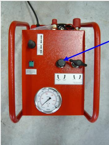
Ouvrir la vanne de **régulation de pression (D)** pour que la pression chute à 0 (tourner dans le sens anti-horaire environ 7 tours).
