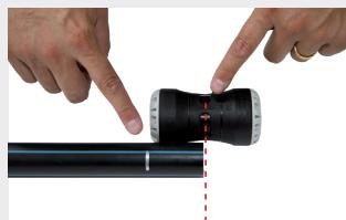
Le tube doit être emboité jusqu'au milieu du raccord. Marquer la profondeur d'emboîtement sur le tube.
