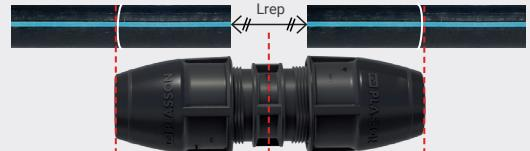
Le milieu du raccord doit être aligné avec le milieu de la longueur à réparer (Lrep).
