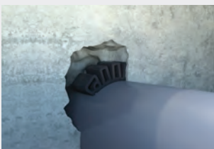
Ancrage du tube dans un mur
