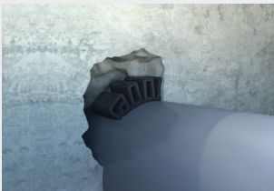
Ancrage du tube dans un mur
