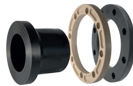
Diamètres 140 mm à 450 mm Composition : 1 collet, 1 bride en acier recouvert de PP 1 anneau anti-fluage et 1 kit de boulonnerie.
