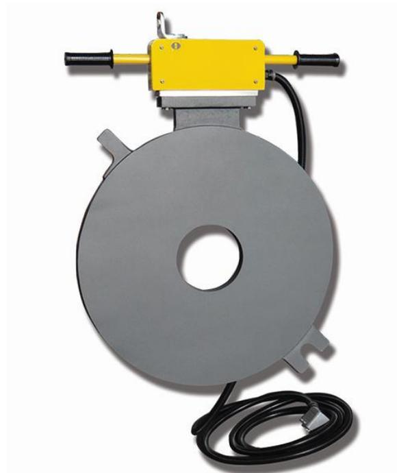
L'élément chauffant doit être obligatoirement connecté au thermostat électrique.
