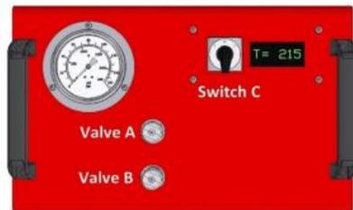
Ouvrir la vanne de **régulation de pression (A)** pour que la pression chute à 0 (tourner dans le sens anti-horaire).
