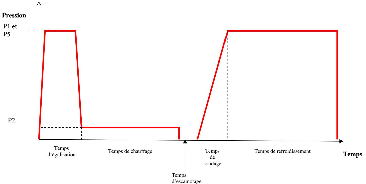
Graphique cycle de soudure pour la soudure bout à bout de tubes et/ou raccords en polyéthylène.
