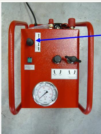
Actionner la **manette de commande (C)** vers « Close »  $\rightarrow \leftarrow$ . La maintenir en position en fermant la vanne de régulation de pression (D) (sens horaire) quand le chariot commence à bouger. Relever la pression indiquée sur le Manomètre (1) au moment du déplacement du chariot (= Pfriction ou Pdéplacement).
