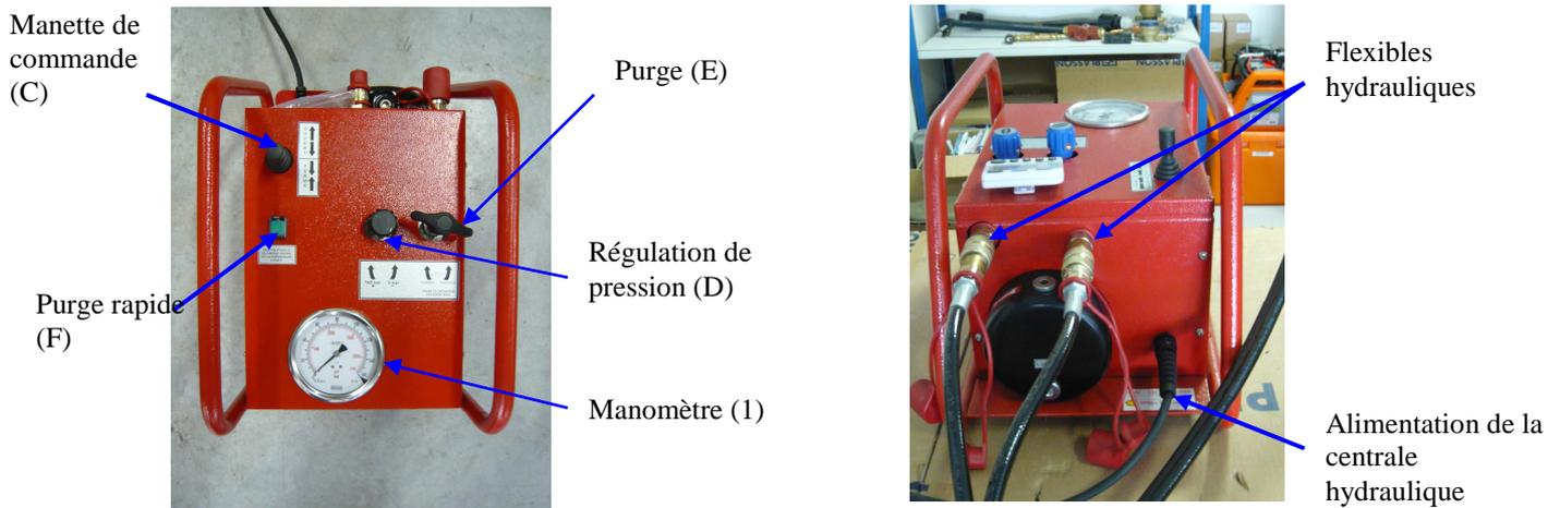
La centrale hydraulique positionnée sur son châssis est compacte et aisément manipulable.
