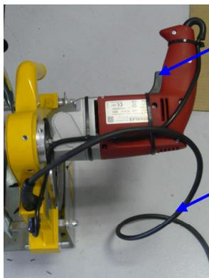
Interrupteur de commande (B)
