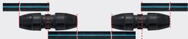
**3** Serrer chaque écrou fermement avec une clé PLASSON (ou équivalent) en maintenant le corps avec une autre clé (les filets ne doivent plus être apparents).
