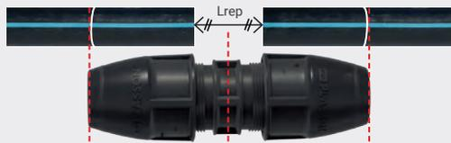
Le milieu du raccord doit être aligné avec le milieu de la longueur à réparer (Lrep).
