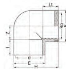
**Coude à 90° avec bague de renfort - A coller sur d - Taraudé sur Rp**
