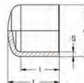
Bouchon de fin de ligne à embout mâle NF 136-GAZ
