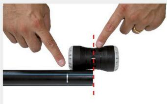
Le tube doit être emboîté jusqu'au milieu du raccord. Marquer la profondeur d'emboîtement sur le tube.
