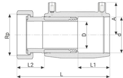
Joint plat NBR pour raccord de transition avec écrou prisonnier en laiton : référence 3043
