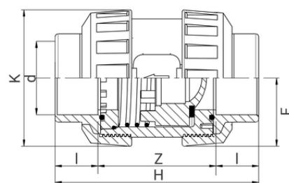
A monter en position verticale ou horizontale. Pmin de fonctionnement = 0,05 bars.
