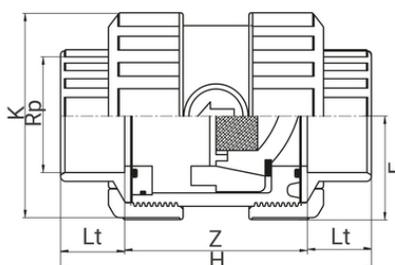
A monter en position verticale ou horizontale. Pmin de fonctionnement = 0,05 bars
