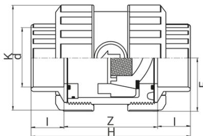
A monter en position verticale ou horizontale. Pmin de fonctionnement = 0,05 bar.
