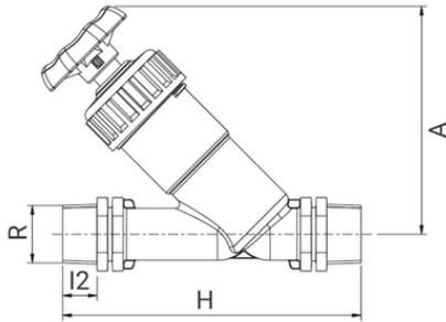
Ne pas forcer pour fermer les soupapes ; on obtient une fermeture complète en tournant légèrement le volant.
