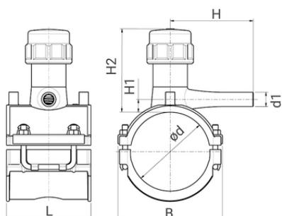
Composition de l'ensemble : 1 prise de branchement munie d'un dispositif témoin étancheur (DTE), 1 manchon électrosoudable et 1, notice de mise en œuvre.
