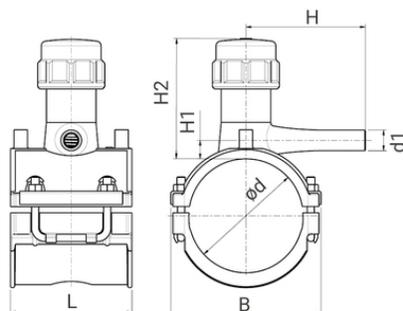
Composition du kit : 1 PBDI D100 munie d'un déclencheur, 1 manchon électrosoudable, 1 collier jaune PBDI, notice de mise en œuvre.
