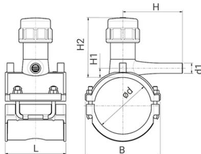
Composition de l'ensemble : 1 prise de branchement, 1 manchon électrosoudable, notice de mise en œuvre.
