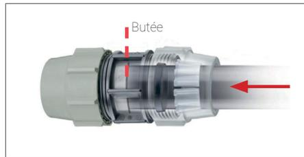
Enfoncer le tube en tournant dans le raccord, traverser la bague de crampage et le joint caoutchouc pour venir en butée contre l'épaulement intérieur.
