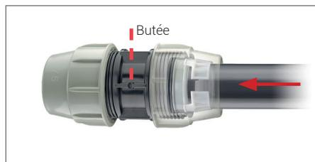
Enfoncer le tube jusqu'à la butée intérieure du raccord.
