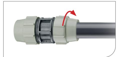
Visser et serrer l'écrou fermement. Utiliser une clé Plasson (ou équivalent) pour les raccords de Ø supérieurs ou égaux à 40mm. L'écrou doit être bien serré mais ne doit pas nécessairement toucher la butée centrale du corps du raccord.
